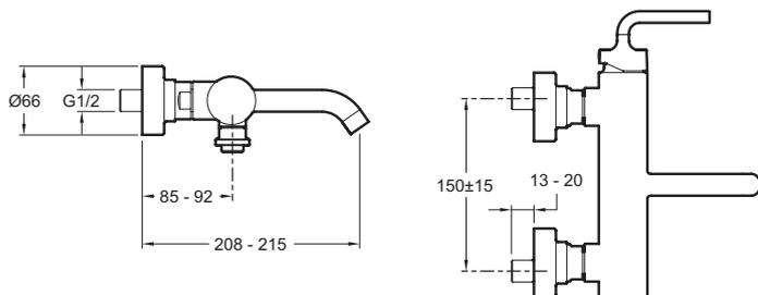
Description : Mitigeur bain-douche mural.. E14589-4A. Collection : PURIST. Poids : 3,5 kg. Type d'installation : Mural. Normes et réglementations : ACS : 14 ACC LY 511. Débit : 23 l/mn sous 3 bars. Raccords : Avec raccords et rosaces murales. Mécanisme : Cartouche à disques céramique. Entraxe :  $150 \pm 15$  mm. Bague-limiteur de température.
