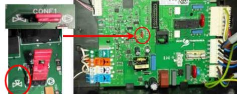
**Mise en place du tableau de commande et raccordement :**
