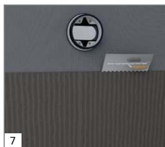
Appliquer une couche de colle en sous-face du receveur et sur le support avec un peigne en denture 10 mm.
