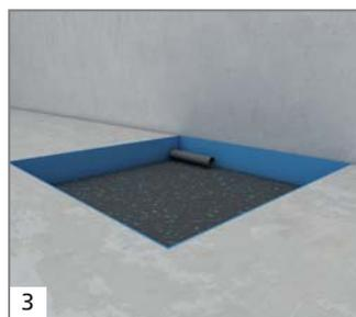
3 Si une réduction aux bruits d'impact est nécessaire, découper et poser Nonstep Plan.
