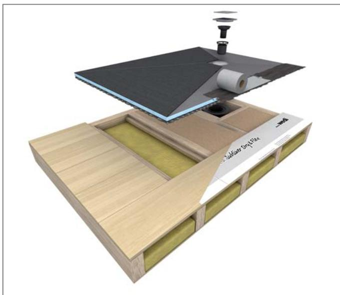
Le receveur à carrelers wedi Fundo Ligno a été spécialement conçu pour une utilisation dans des constructions neuves sur des planchers en bois (lames de bois, OSB, CTBX, CTBH...). Avec la version intégrée représentée ici, le traitement des jonctions au niveau de la construction en bois attenante s'effectue avec le kit d'étanchéité wedi Fundo.
