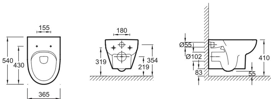
Descriptif CCTP : Cuvette suspendue sans bride RIMOVE basse consommation. E4570. Collection : ODÉON UP. Dimensions : 54 x 36,50 cm. Poids : 24,8 kg. Matériau : Céramique. Type d'installation : Suspendu. Normes et réglementations : NF. Consommation d'eau : 2,6/4 L et 3/6 L. Type de bride : Sans bride. Semi-carénée.
