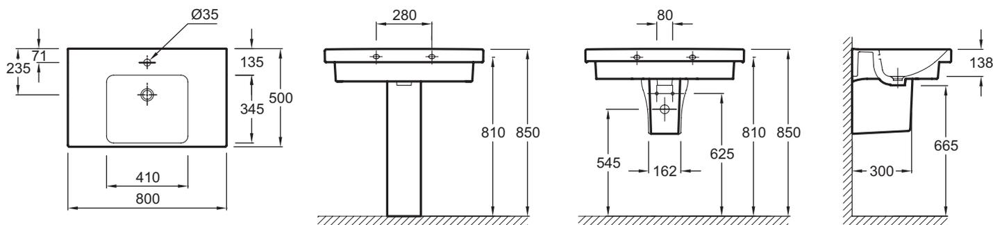
Description : Plan-vasque 80 cm. E4796. Collection : ODÉON UP. Dimensions : 80 x 50 cm. Poids : 26,6 kg. Matériau : Céramique. Type d'installation : Autoportant ou peut être monté sur un meuble spécifique. Percement et pré-percement robinetterie : Percé 1 trou de robinetterie. ROBINETTERIE CONSEILLÉE : Aleo, une gamme design très accessible.
