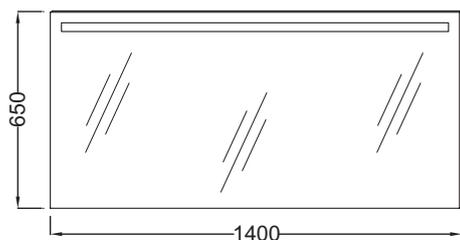
Descriptif CCTP : Miroir 140 cm avec éclairage LED et antibuée. EB1420. Collection : HORS COLLECTION. Dimensions : 140 x 3 x 65 cm. Poids : 16 kg. Type d'installation : Mural. Électricité : 230V, 15W, classe II IP44.
