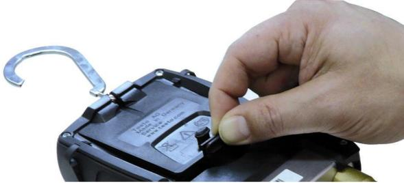
1. Relevez le dispositif d'accrochage, détachez le clip et retirez le couvercle du compartiment à piles.
