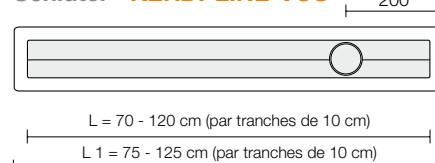
Coupe transversale – Montage au centre de la douche
